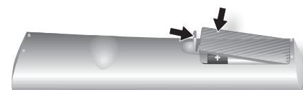
3. Plaats het deksel terug op het batterijvakje, sluit de tab tot u een klik hoort.
