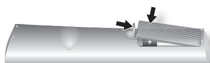
3. Setzen Sie die Batteriefachhülle wieder auf und lassen Sie die Klappe mit einem Klick einrasten.
