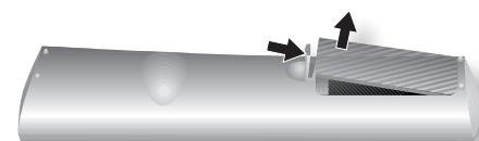
1. Knijp de tab in en verwijder het deksel van het vakje met de batterijen.
