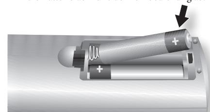
2. Legen Sie die beiden mitgelieferten AAA-Batterien in der richtigen Ausrichtung entsprechend den Markierungen + und - im Batteriefach ein.
