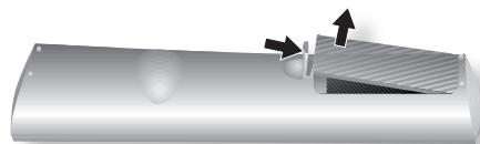
1. Drücken Sie auf die Klappe und nehmen Sie die Batteriefachhülle der Fernbedienung ab.
